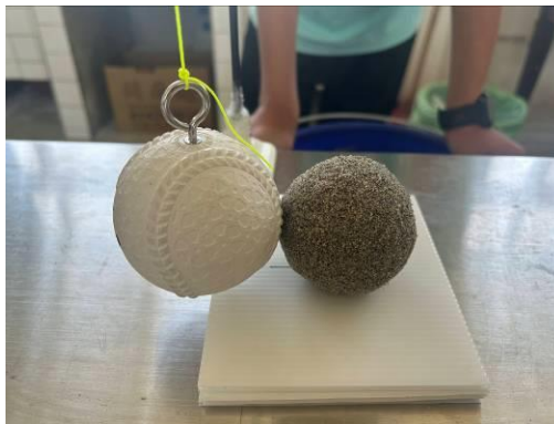
照片 12.將沙球放置於撞擊平台(可調高度)
