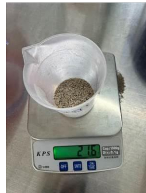
照片 15.本地沙灘沙子以粗篩網過篩大顆粒極少 照片 16.以極細網過篩僅能篩掉約 2%沙粒
