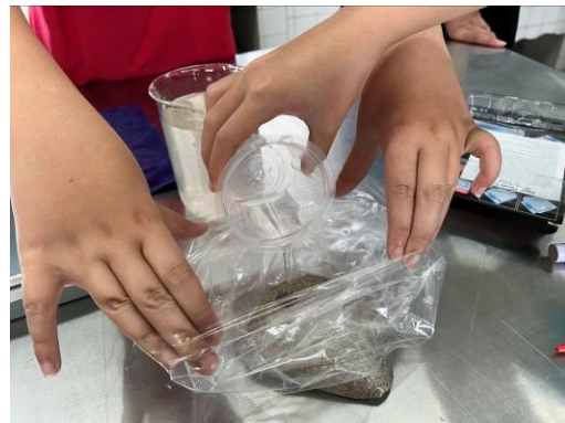
照片 4.倒入指定的水量後輕揉混勻
