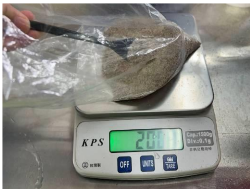
照片 3.秤取 200 克乾沙(要先歸零喔)
