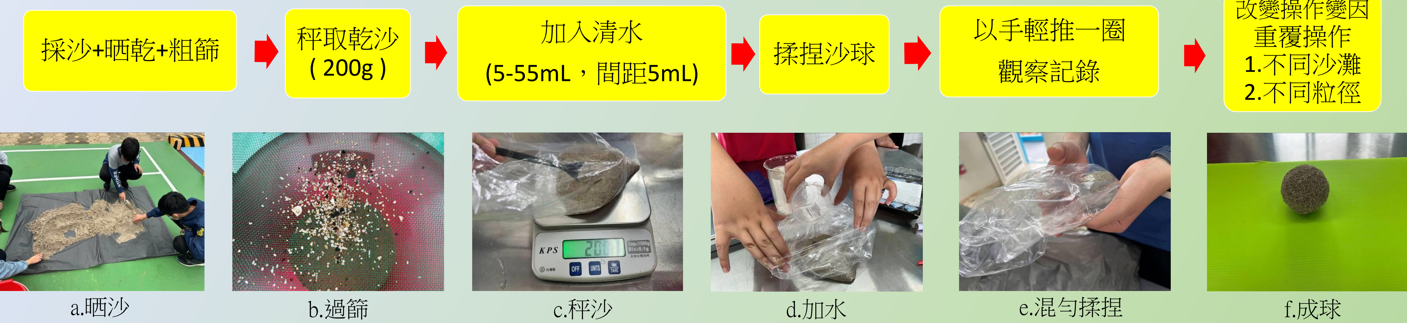
照片2.製作沙球的基本流程
