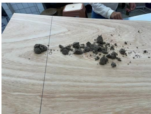
照片 27.太乾的沙球一滾動即破碎
