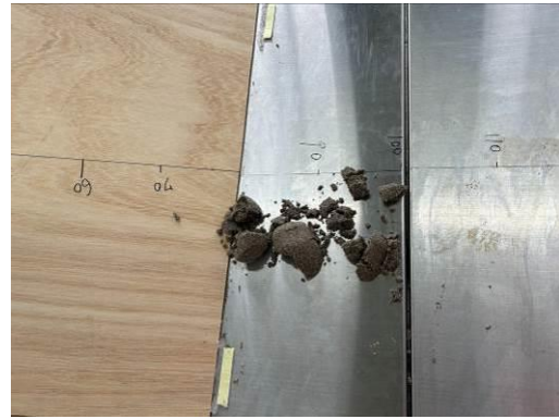
照片 30.坡度過大沙球耐不住接縫處撞擊
