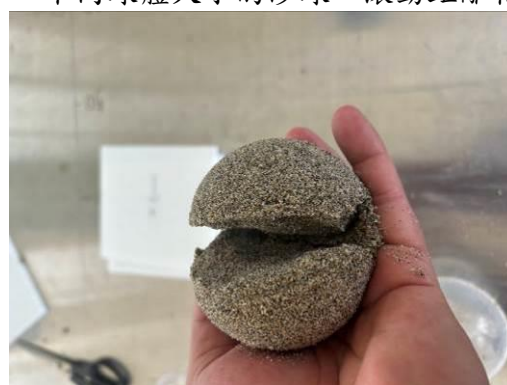
照片 31.最後以扭蛋殼加壓，沙球更圓 照片 32.直接用扭蛋殼製球，易從接縫裂開
