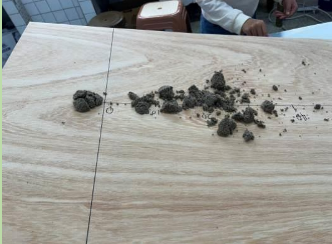
照片18.沙球太乾一滾就破
