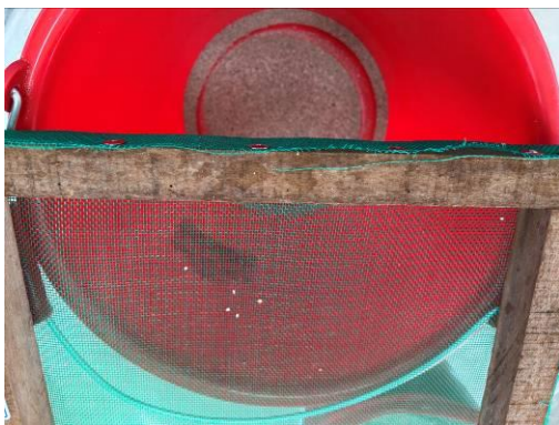
照片 15.本地沙灘沙子以粗篩網過篩大顆粒極少 照片 16.以極細網過篩僅能篩掉約 2%沙粒
