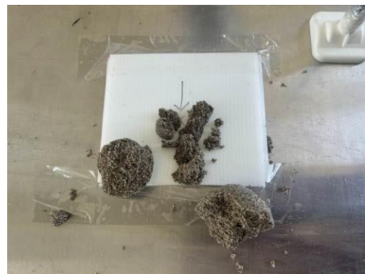
照片 34.撞擊至沙球破碎才算實驗完成
