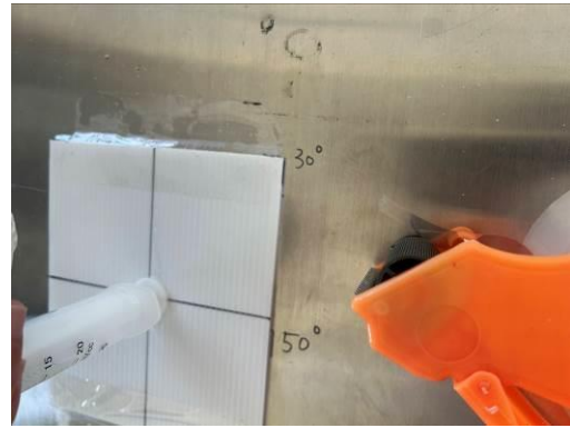
照片 36.設置好位置後可用膠帶固定
