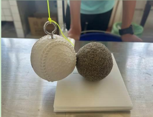
照片 24.用瓦楞板調沙球高度
