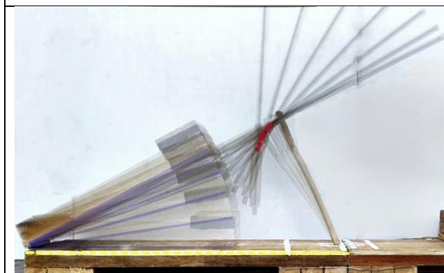
標記 35 連續圖。(圖 39) 重壓板落地 0.28 秒。撐重桿影像標示越散，代表轉動效應越強。
