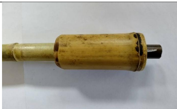
箭竹外包覆桂竹使撐重桿較易撐起重壓板(圖 68)
