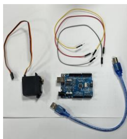
圖 3-15 杜邦線、Arduino uno 板、伺服馬達、USB 線
