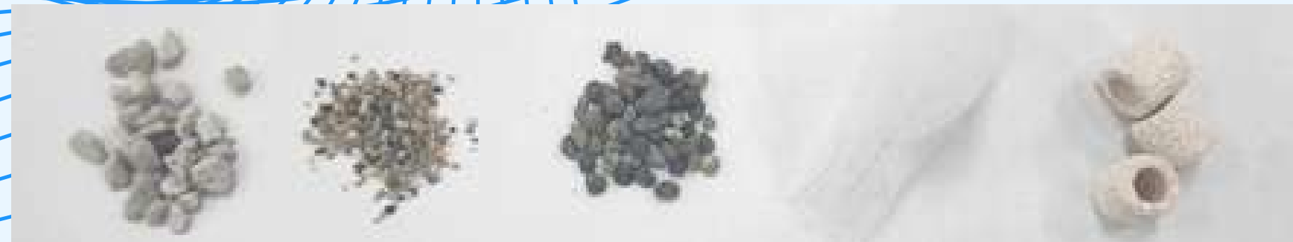
圖11.濾材(從左至右分別是火山石、石英砂、石英石、過濾棉、陶瓷濾材)
