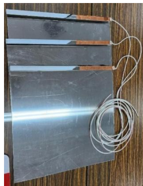
圖 4. 自製電場電極片(大)
