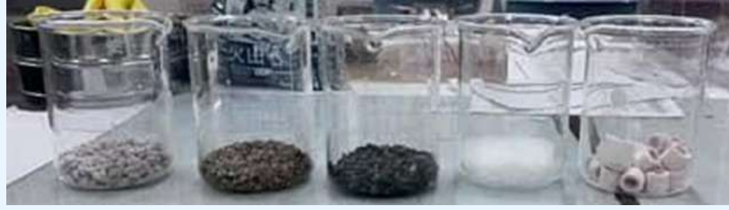
圖28.濾材(從左至右分別是:火山石、石英砂、石英石、過濾棉、陶瓷濾材)
