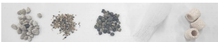
圖 13. 濾材(從左至右分別為：火山石、石英砂、石英石、過濾棉、陶瓷濾材)
