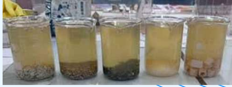
圖29.濾材與淨化後生態池水剛到大水樣 示意圖(從左至右分別是:火山石、石英砂、石英石、過濾棉、陶瓷濾材)
