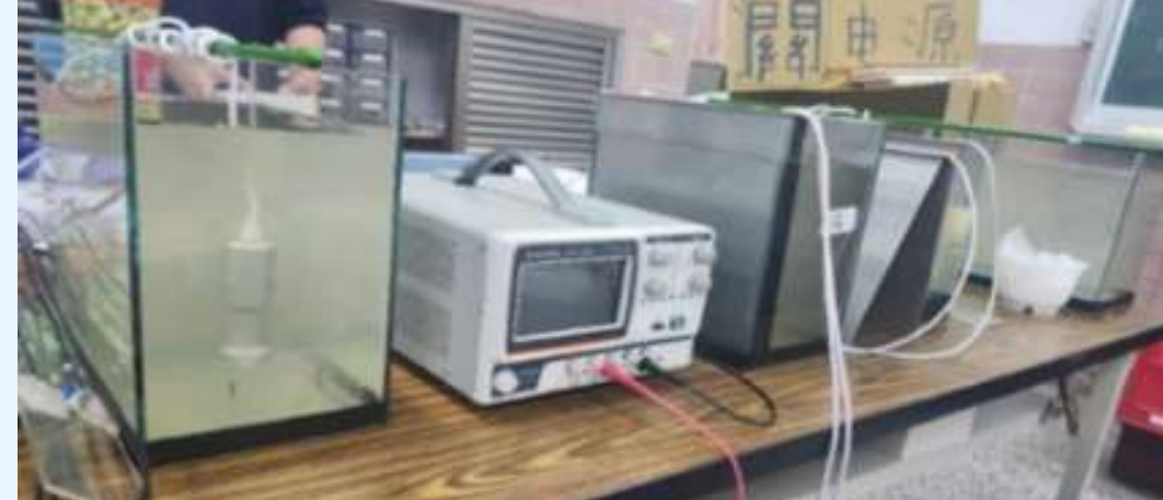
圖23.水缸與直流電源供應器擺放示意圖
