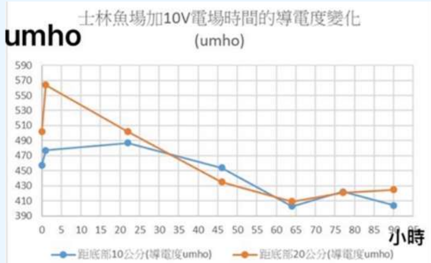
圖34.加10V電場的導電度變化
