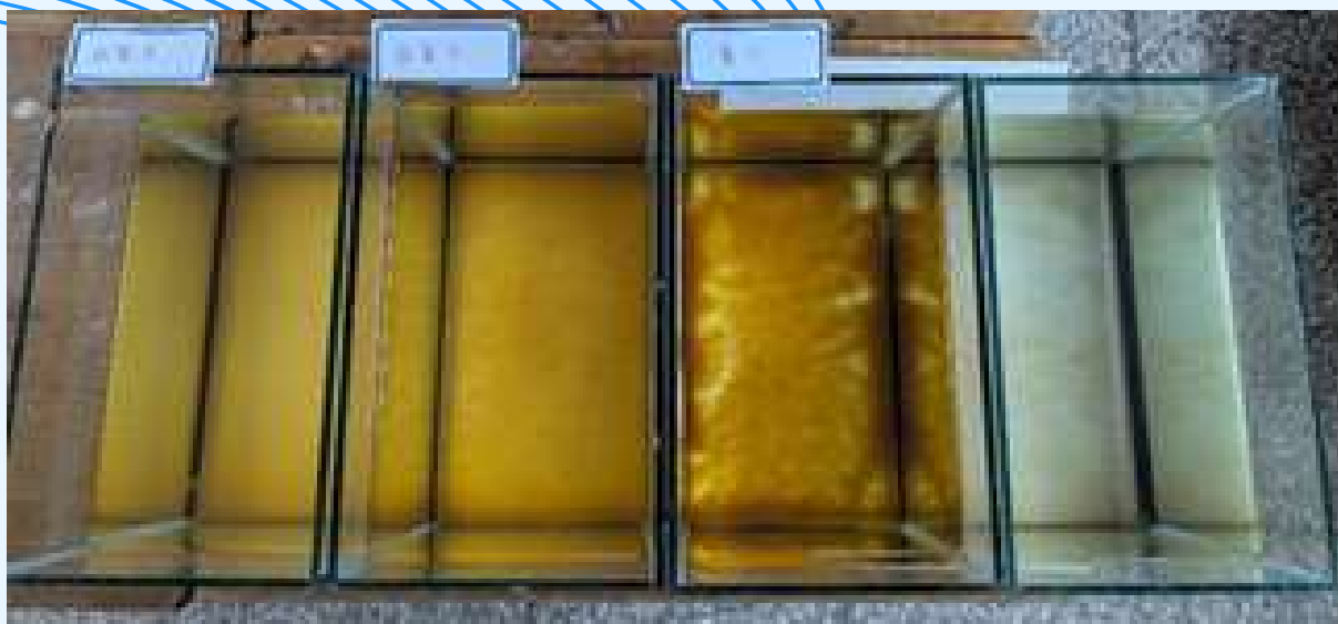
圖52.第三階段第二次實驗沉澱情況。由左至右：超電A、超電B、電C、未淨化池水
