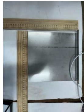
圖 5. 自製電場電極片(小)
