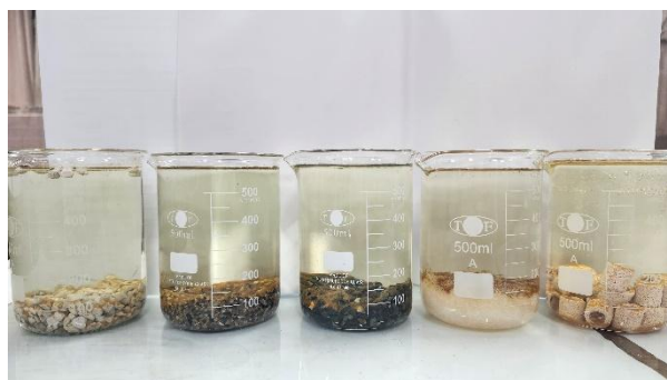
圖 56. 五種底材沉澱結果
