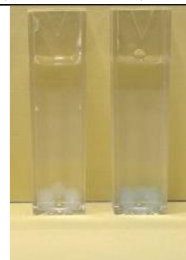
【圖】檢測球的工作情況，左為蒸餾水；右為自來水(作者自行拍攝)
