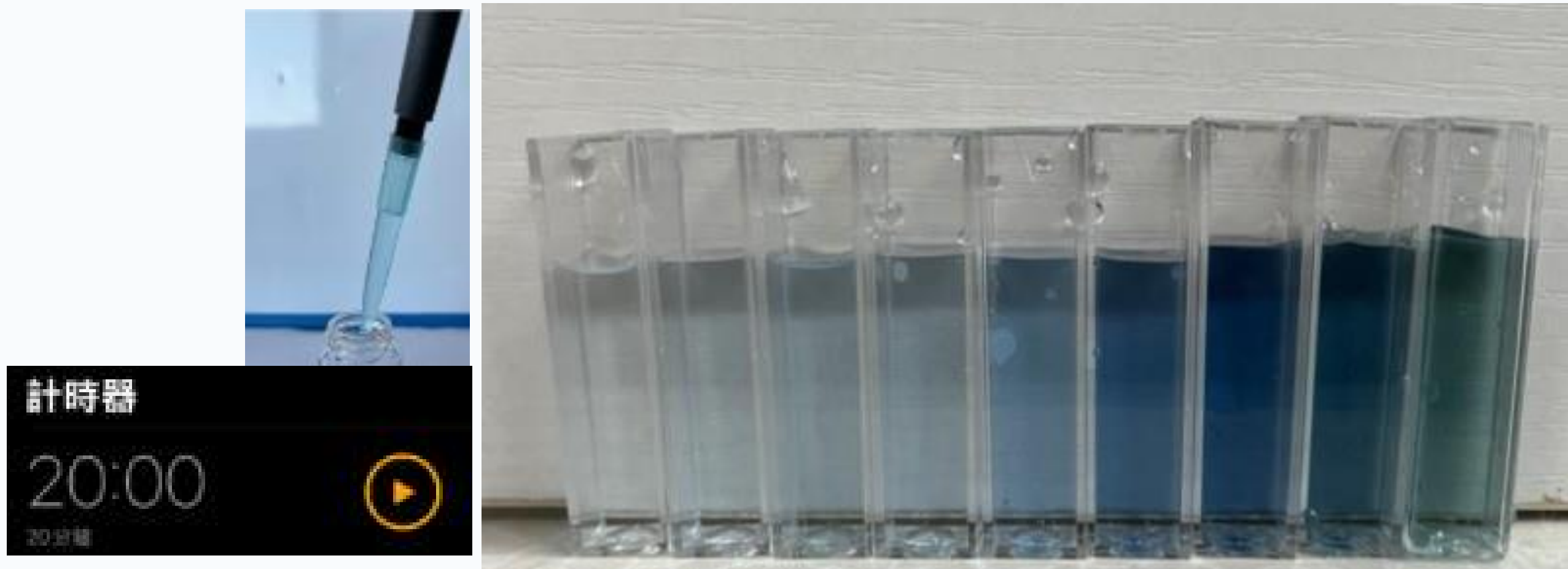
【圖】由左至右分別為 10^{-6} ~ 10^{-5} M 之標準磷酸根水樣；檢測配方(鉬酸根：維他命C = 10^{-2} ： 5 \times 10^{-4} M)
