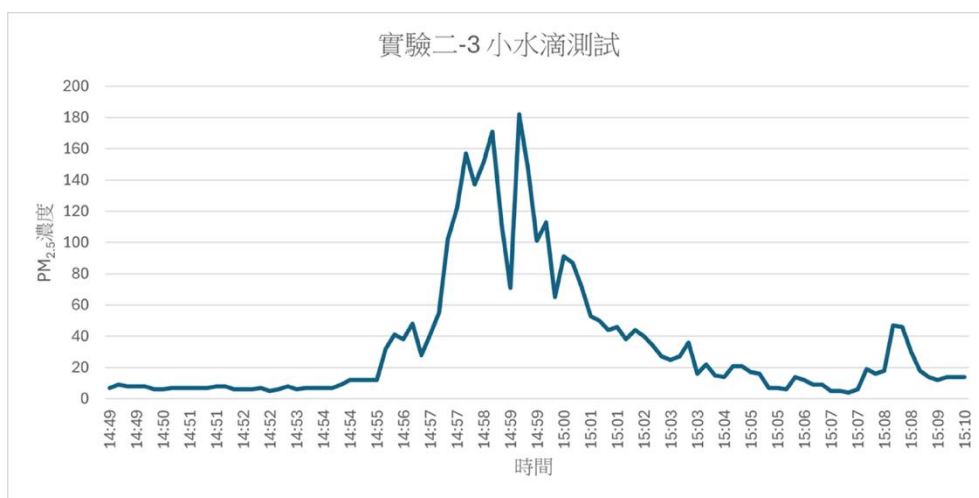
圖十一：實驗二-3，擺放一盆熱水時 PM_{2.5} 濃度的變化（圖片來源：研究者自行繪製）
