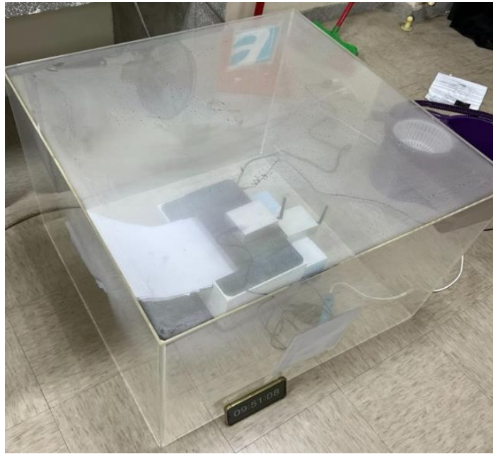
圖十：進行實驗二-1 與實驗二-2 時觀測到壓克力箱箱壁上附著大量小水滴（圖片來源：研究者自行拍攝）
