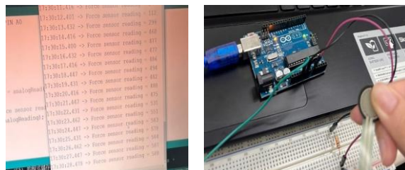
圖 3-19 程式執行畫面與 Arduino 連接壓力感測器(資料來源：作者自行拍攝)
