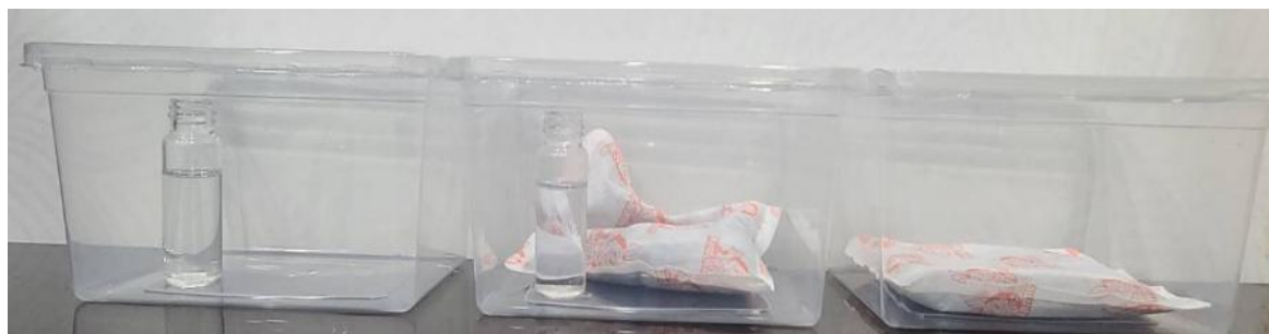
圖 2 廢棄暖暖包除溼能力測試裝置
