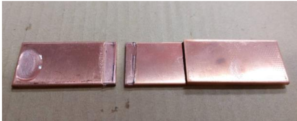
圖一、銅片的破裂面展示(圖源：作者拍攝) 圖二、鋁片的破裂面展示(圖源：作者拍攝)
