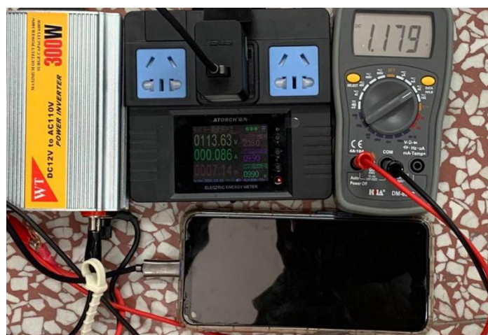
圖5-1 逆變器實驗 低耗電的只有約50%效率、高耗電80%效率
