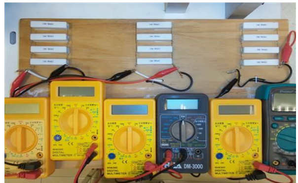
圖 10 水泥電阻負載治具(本圖由作者拍攝)
