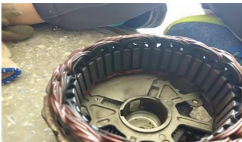
圖 54 1.3kw 傳統車用單轉子發電機發電線圈(欲改裝為外轉子) (本圖由指導教師拍攝)
