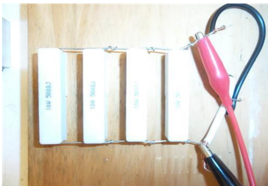
圖 9 水泥電阻負載治具(本圖由作者拍攝)
