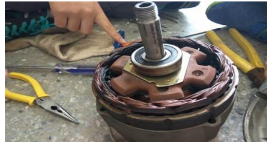
圖 55 內、外轉子改組裝示意圖 (本圖由指導教師拍攝)
