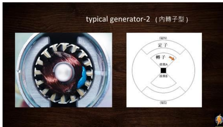
圖 5 內轉子發電機及結構示意圖(左圖由指導教師拍攝，右圖由作者製作)
