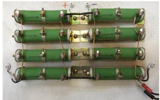
圖 8 水泥電阻負載治具(本圖由指導教師拍攝)
