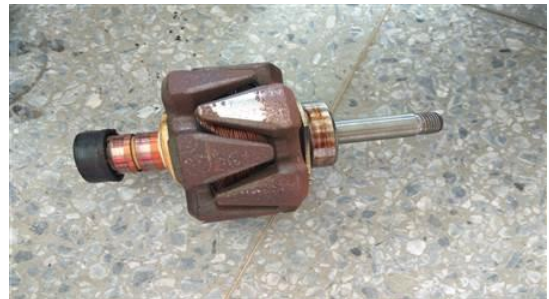
圖 53 1.3kw 傳統車用單轉子發電機磁芯(欲改裝為內轉子) (本圖由指導教師拍攝)
