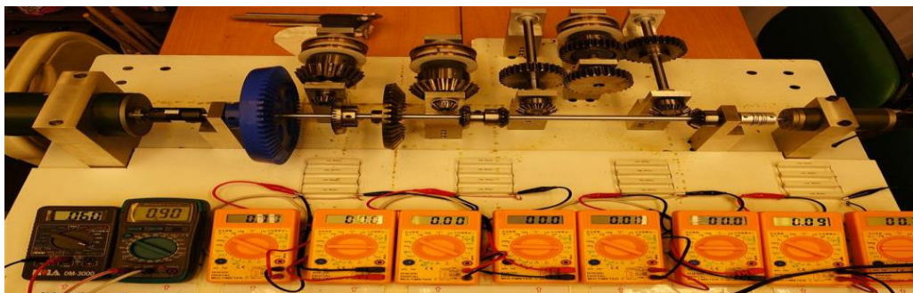
圖 11 同步測試 CG、11SG、22SG、33SG 發電效能 裝置圖(本圖由作者拍攝)
