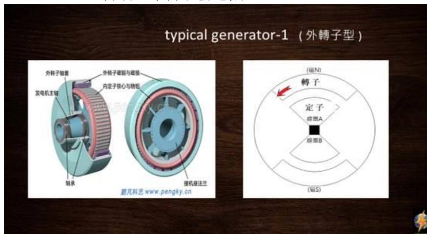
圖 4 外轉子發電機及結構示意圖(左圖片引自鵬凡科藝網站，右圖由作者製作)
