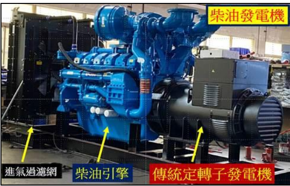
圖 42 一般市售單轉子柴油發電機組
