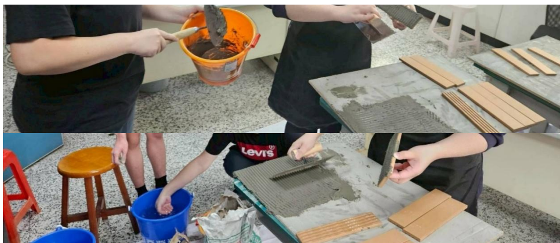
圖11、實驗磁磚製作 (資料來源：由作者自行拍攝)
