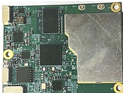
圖7、數圖傳模塊 (資料來源：由作者自行拍攝)
