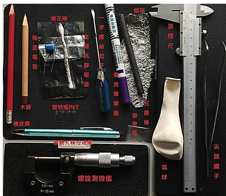
圖10. 電容式觸控筆材質實驗器材 [自製圖]
