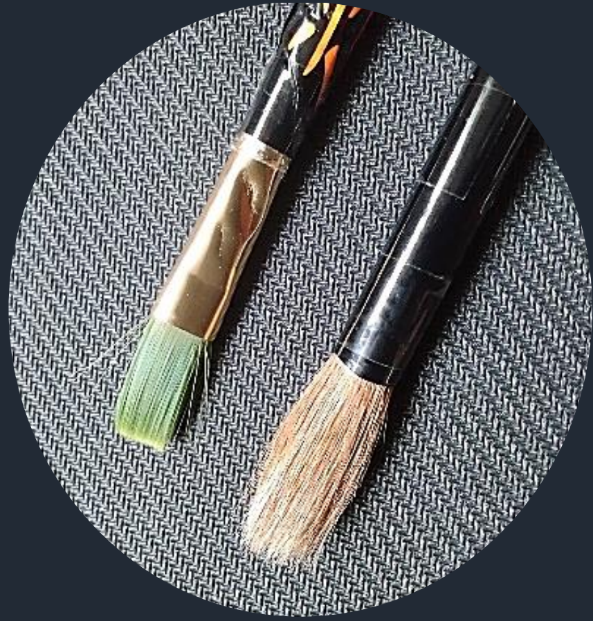
圖17~18. 自製全擬真被動式電容式觸控毛筆/水彩筆與其結構圖(自製圖) 圖20.投射電容觸控面板互電容感測觸控毛筆示意圖[53]
