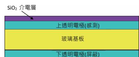
圖2. 表面式電容觸控結構示意圖[8]
