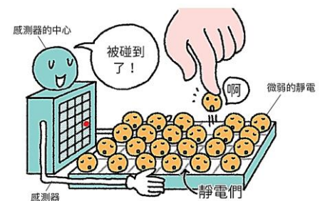
圖1. 電容式觸控面板構造示意圖[7]
