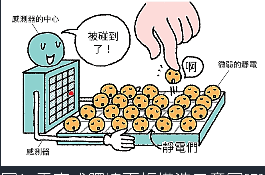
圖1. 電容式觸控面板構造示意圖[7]
