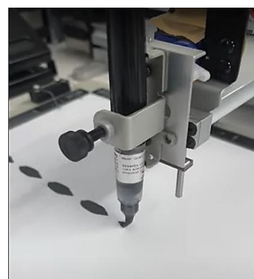
圖13. 機械手臂握毛筆書寫測試示意圖 [31]
