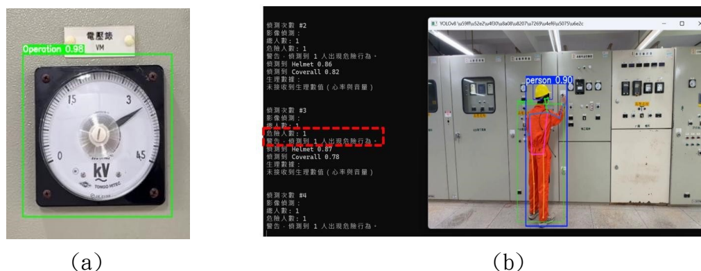
圖 30 配電盤通電辨識。(a)電壓錶 3.3 KV 辨識圖，(b)作業人員於通電時操作辨識 本圖由作者親自製作。
