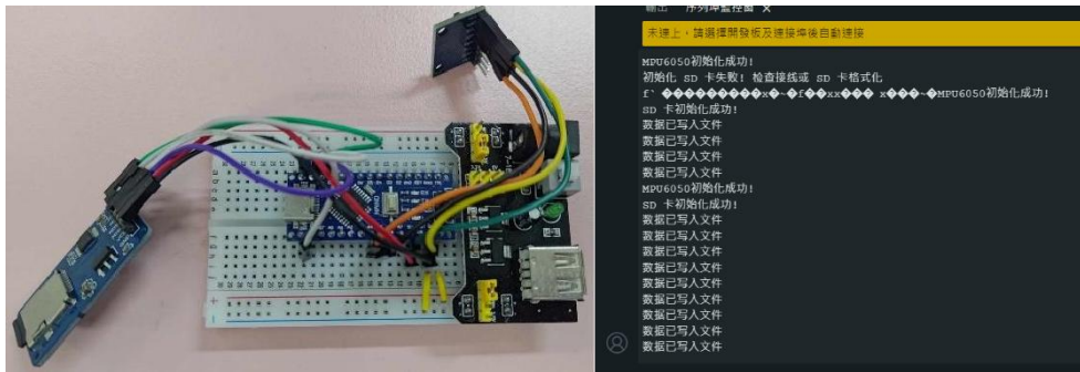
圖(20)、左：姿態測量電路 右：連接電腦測試數據寫入 SD 卡(作者自行拍攝)
