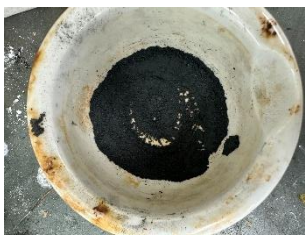
圖十：二氧化鈦改質鋁鎂生物炭 (由作者拍攝或繪製)
