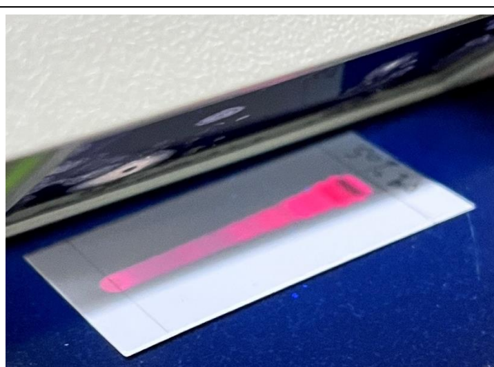
圖七、以短波照射 TLC 片檢測是否分解
