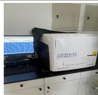
圖十一、使用多模式微量盤分析儀測定不同酵素在添加賽滅寧後的活性
