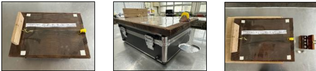
圖 12 本試驗中自製的拉伸延展性測試裝置(作者自攝)
