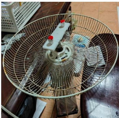
圖十八、自製之 60 瓦交流掛扇 轉速 44 \pi/s \sim 56 \pi/s
