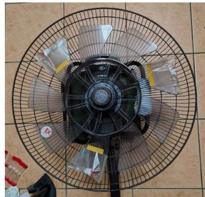
圖十九、17 瓦直流立扇 轉速 5.6 \pi/s \sim 21 \pi/s
