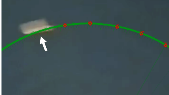
圖 9 Tracker 程式計算畫面。綠色圓為白蟻尚未拋出的軌跡，紅色點為白蟻恰脫離原始位置前的影格，白色箭頭指向恰脫離原始位置之白蟻沿切線方向飛出。 (作者自行拍攝、繪製)
