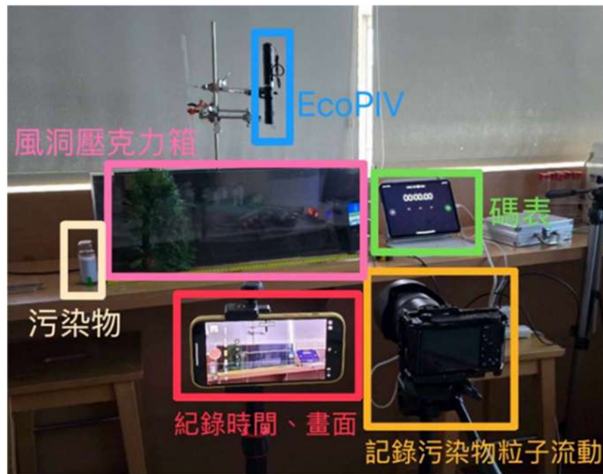
圖 5 實驗設置。自製壓克力風洞，以噴霧器釋放水霧粒子作為污染源，上方設置自製的 EcoPIV 量測流速場。（作者自行拍攝與製作）
