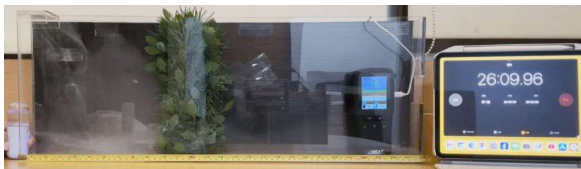
圖 4 實驗過程快照。噴霧器由風洞左側噴入水霧粒子，空品儀顯示 PM2.5 數值，右側放置計時器，記錄 PM2.5 隨時間的變化。（作者自行拍攝）
