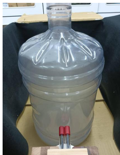
圖十六、加壓後拔開塞子並產生模擬雲氣。 (作者自行拍攝)
