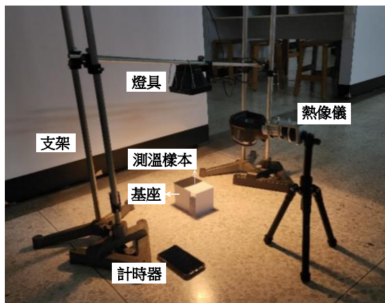
圖 3-1：熱輻射與熱傳導實驗裝置
