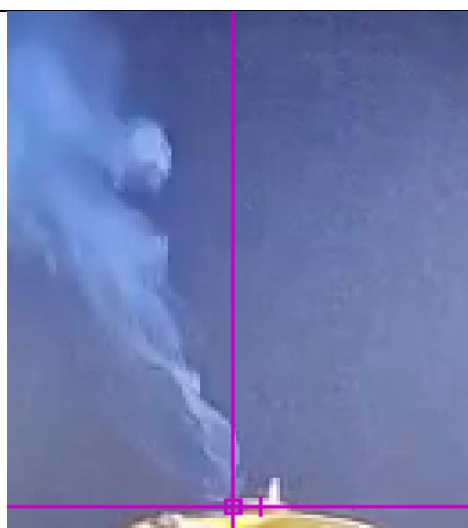
圖十三:離子風使煙場偏折 (第一作者拍攝與分析)
