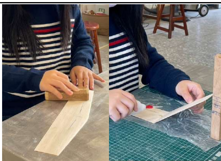
圖五、左右機翼細磨與拼接黏合
