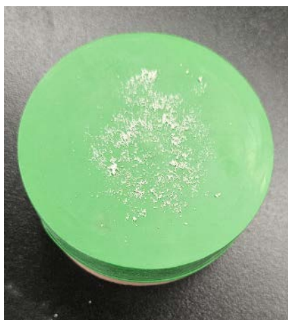
圖 1、氣球皮以聲音趨動砂子無法呈現出共振模態(自行拍攝)
