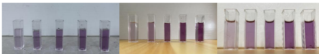
0.5%水楊酸、1.0%水楊酸、2.0%水楊酸製作之不同鐵離子比例水楊酸酚鐵溶液
