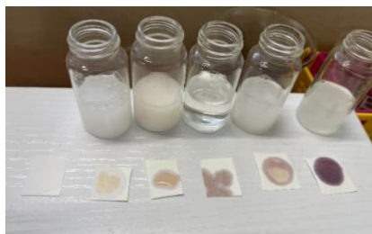
步驟 14-2 將產品樣本溶液滴上試紙
