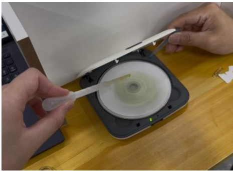
【圖】利用光碟機作為旋轉塗布的機器 (作者自行拍攝)
