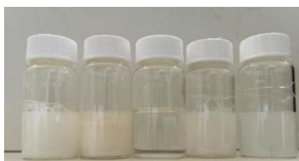
步驟 14-1 浸泡洗面乳於水中，將水楊酸 溶解出形成檢測樣本
