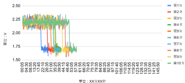
圖(十二)：加入硫酸鋅的電壓時間圖 (圖(十二)為實驗結果整理自行繪製)
