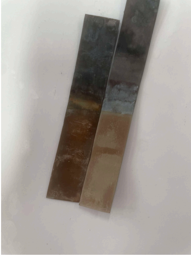
電極板產生不可逆硫酸鉛示意圖
