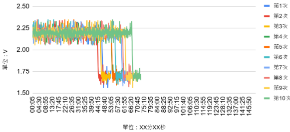
圖(十三)：加入硫酸鉀的電壓時間圖 (圖(十三)為實驗結果整理自行繪製)
