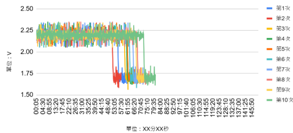
圖(四十四)：加入 0.01 莫耳的電壓時間圖 (圖(四十四)為實驗結果整理自行繪製)
