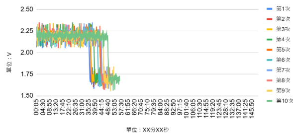
圖(二十五)：加入 0.005 莫耳的電壓時間圖 (圖(二十五)為實驗結果整理自行繪製)
