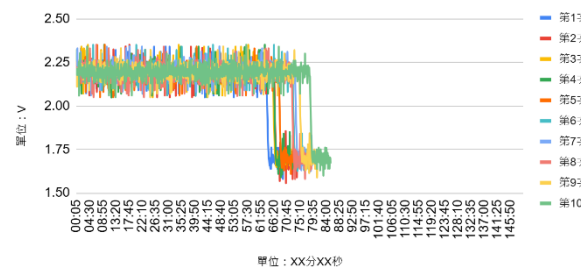
圖(十五)：加入硫酸鋁的電壓時間圖 (圖(十五)為實驗結果整理自行繪製)
