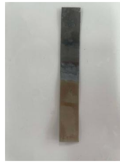
圖(二)：自製鉛蓄電池圖 圖(三)：鉛蓄電池電極板附著不可逆硫酸鉛
