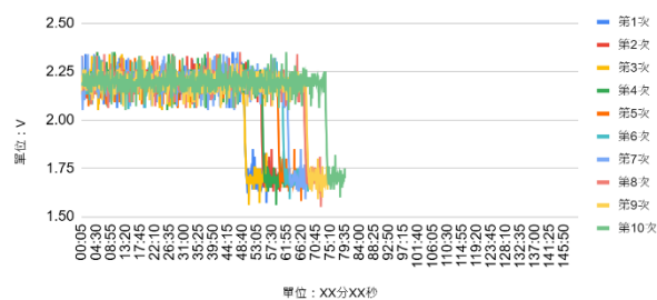
圖(四十)：加入 0.01 莫耳的電壓時間圖 (圖(四十)為實驗結果整理自行繪製)
