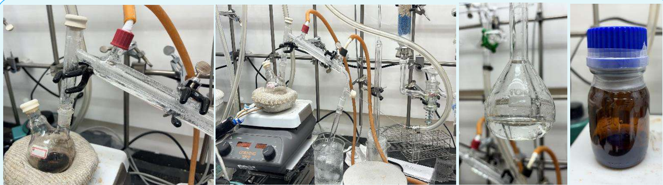
A. 純化前暗色黏稠液體 B. 抽真空、加熱蒸餾 C. 純化後澄清無色液體
