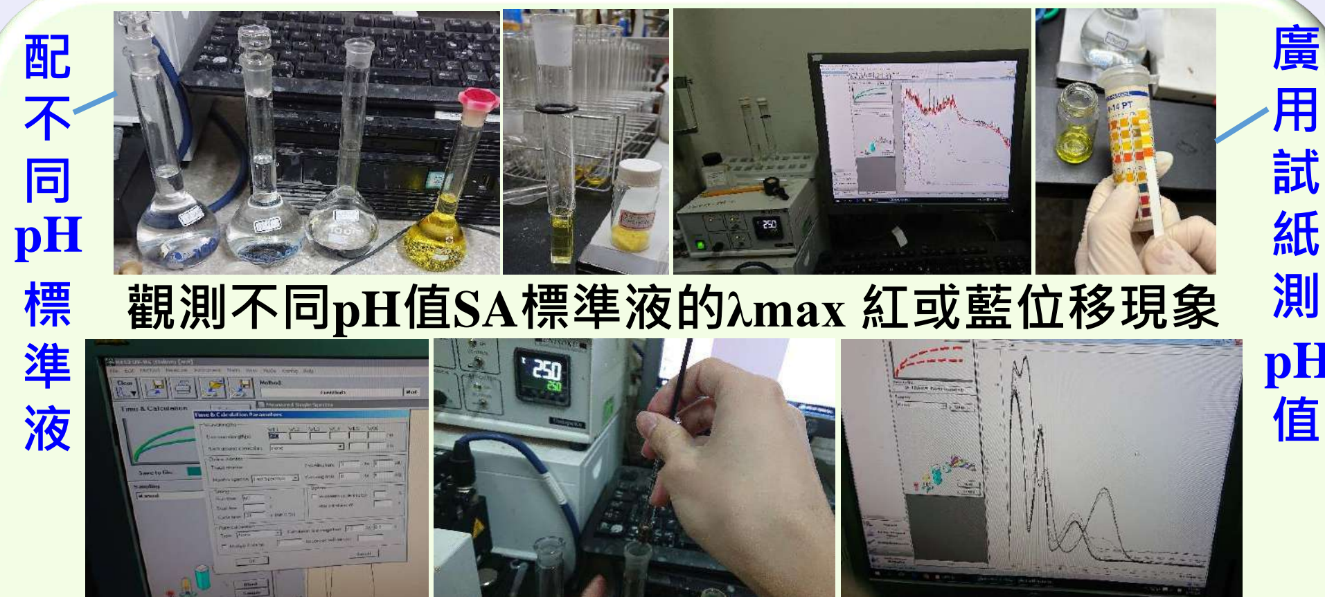
A. 時間掃描條件設定 B. 氣密針注入酸液 C. 測酸化過程λ max D. 觀測不同pH值SA標準液的λ max 紅或藍位移現象
