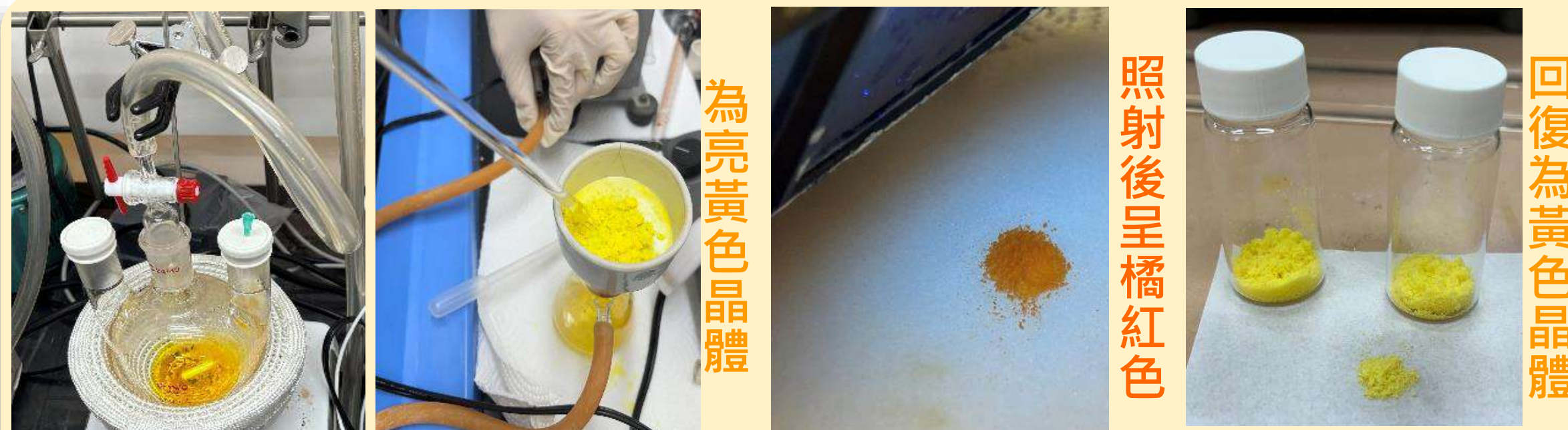
A. 為黃褐色溶液 B. 抽氣過濾 C. 照短波UV D. 再照可見光
