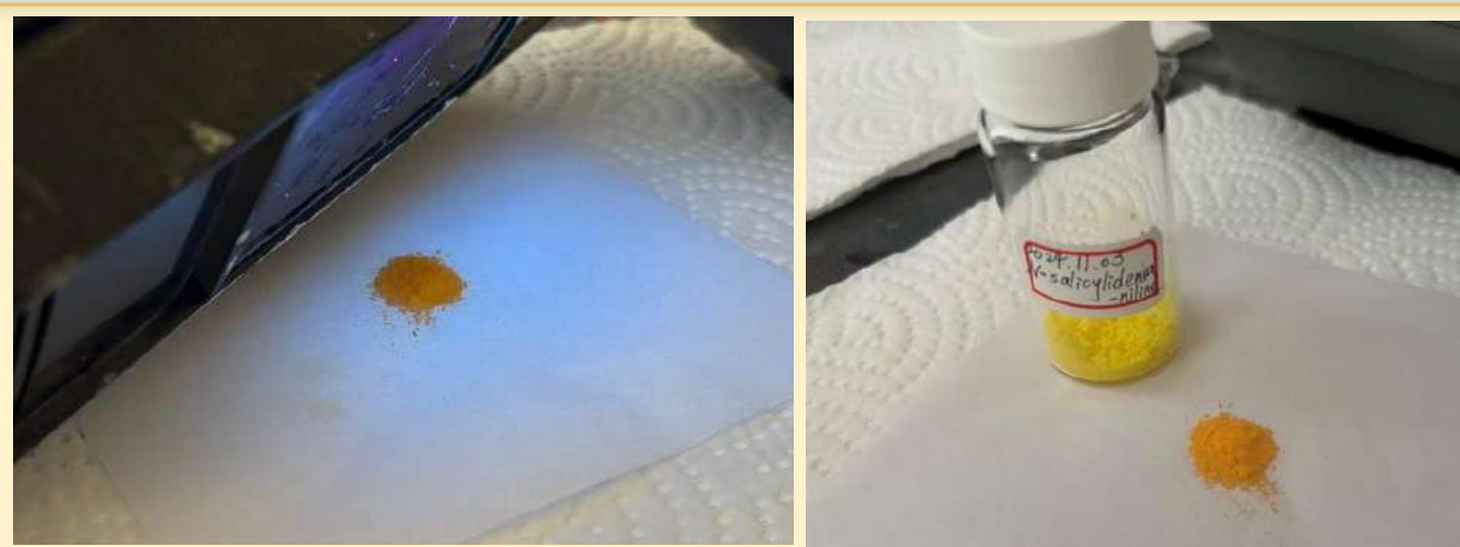
圖1. SA晶體照射短波(254nm)紫外光前後的光致變色現象
