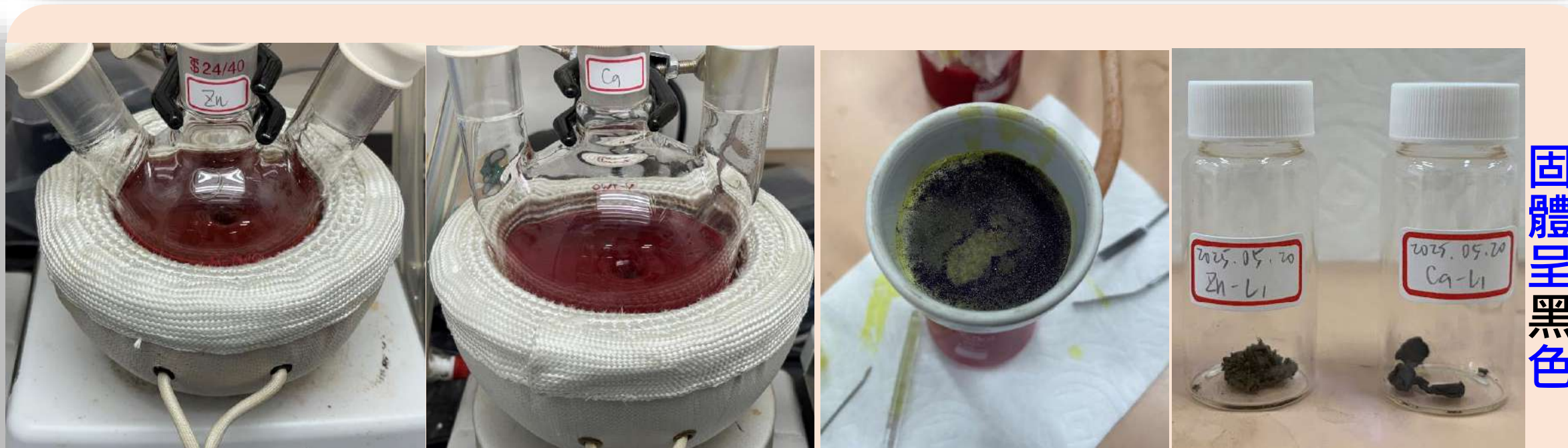
A. Zn-L1、Ca-L1反應加熱 B. 抽氣過濾 C. 抽濾後的固體
