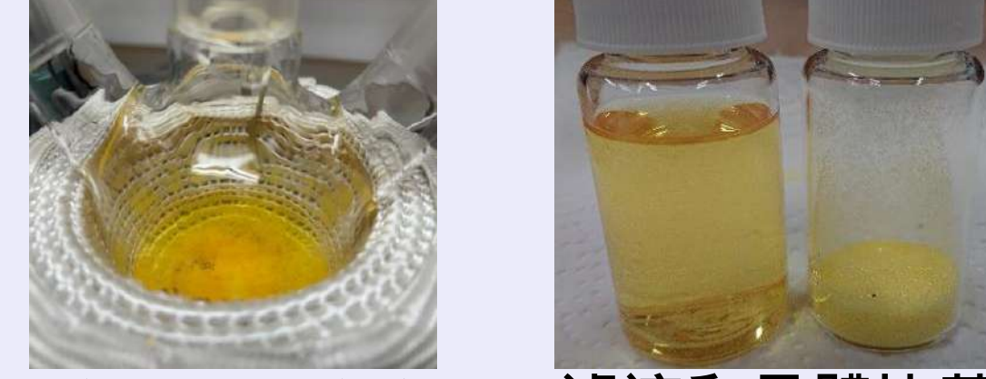
A.通N 2 加熱迴流 B.濾液和晶體皆黃色 C.照365nmUV
