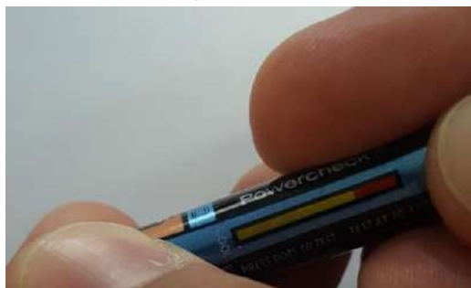
圖6. 電池測電條為熱致變色液晶分子，壓住兩端電流通過電阻薄片生熱效應(本圖為作者拍攝)
