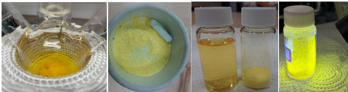
圖15. 合成 SB2 氮氣迴流實驗 濾液和晶體 長波365nmUV 照射 (本圖為作者/指導老師拍攝) 皆黃色! 為螢光黃色!
