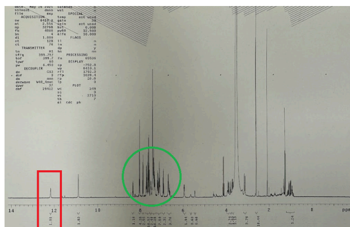
圖二十五:7~10號試管收集產物的NMR圖譜，紅色框框為目標產物的其中一根訊號，綠色圈圈為芳香環區) 研究者本人拍攝
