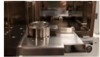
圖七、SEM 樣品載台操作圖 （圖中小碟）（作者攝影）
