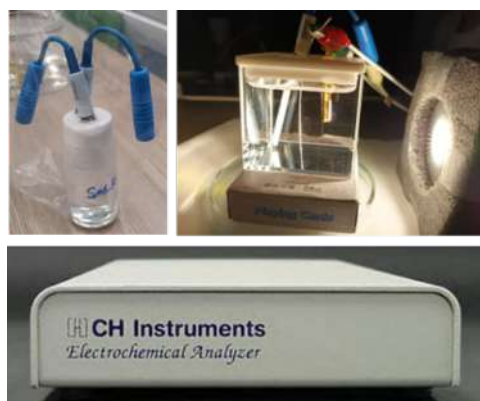
圖十四、左上：Ag / AgCl 標準電極； 右上：電化學裝置操作情形；下：可 攜式微型電化學分析儀 (作者拍攝)
