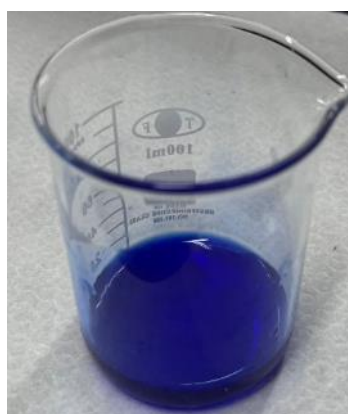
圖1- 3纖維素溶於水後形成藍色黏稠溶液 (本圖片由作者親自拍攝)
