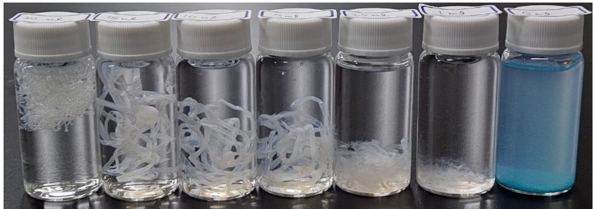
圖4- 38不同濃度成型液對碳酸銅製程纖維的影響 (由左至右依序為3.47、2.6M、1.73M、0.87M、0.43M、0.17M、蒸餾水)
