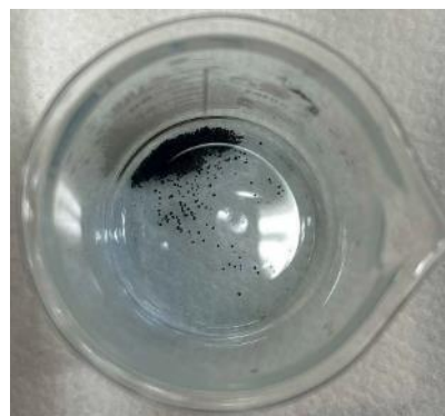
圖4- 7銅鋅粉混合物僅微溶於氨水
