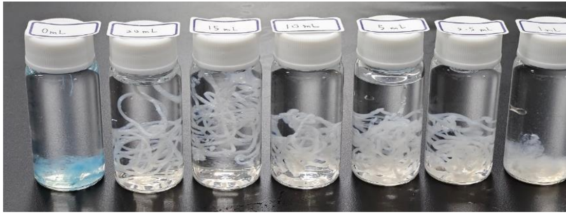
圖4- 37不同濃度成型液對銅箔製程纖維的外觀 (由左至右依序為蒸餾水、3.47、2.6M、1.73M、0.87M、0.43M、0.17M 硫酸溶液)
