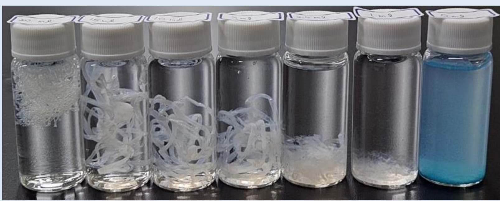
圖3-50不同濃度成型液對碳酸銅製程纖維的影響
