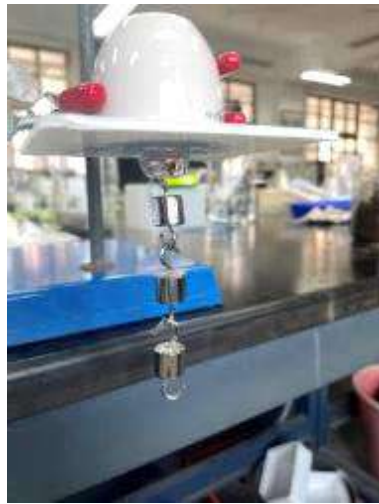
圖 9、圖 10、於塑膠板掛上雙勾砝碼過程 (*圖片出處註 1)
