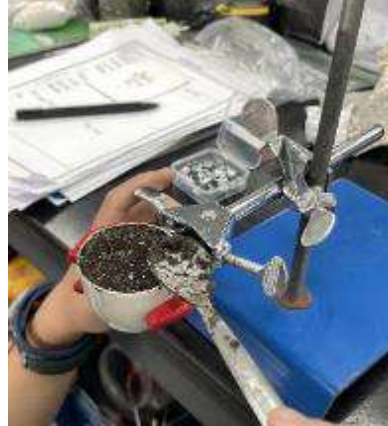
圖 6、以藥匙底面貼平土壤面 (*圖片出處註 1)
