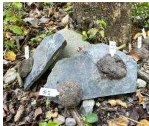
圖 36、SA-0.5 種子球、SA-0.4+MC-0.4 種子球 與對照組於乾燥後於岩板附著情形 (*圖片出處註 1)
