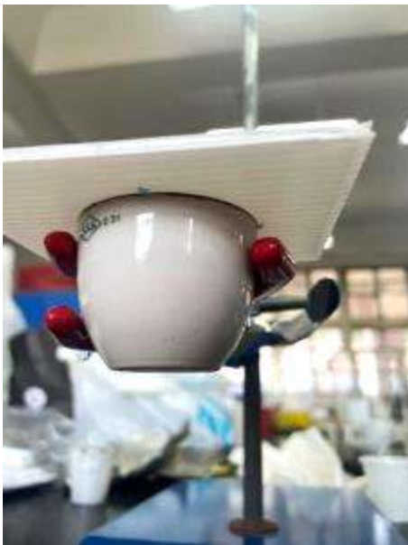
圖 7、塑膠板面貼合坩堝口的土壤面 (*圖片出處註 1)
