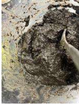
圖 5、土壤表面滲出水膜情形 (*圖片出處註 1)
