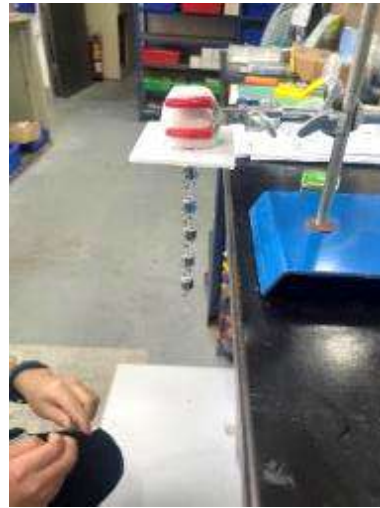
圖 9、圖 10、於塑膠板掛上雙勾砝碼過程 (*圖片出處註 1)
