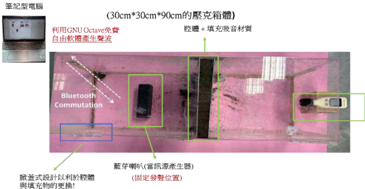
圖 3-4 自製壓克力立體測試箱及相關設備位置說明
