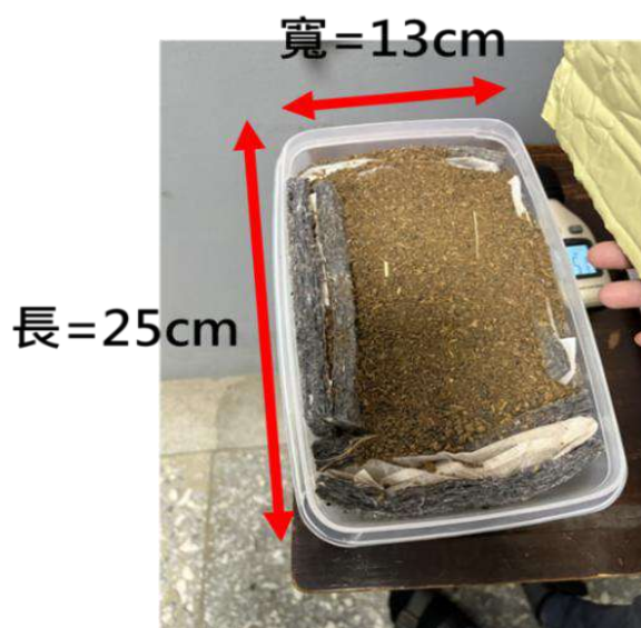
圖 3-33 咖啡渣厚度(披覆量)實驗說明 本圖為研究者自行製作
