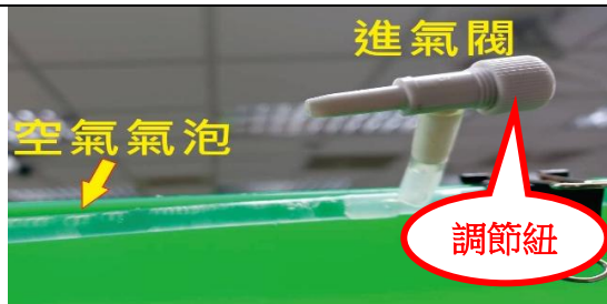
圖5 利用進氣閥調整氣泡大小 (本照片由作者/指導老師拍攝/製作)
