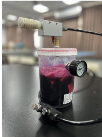
▲下方為可調控罐內氣體負壓值的「調壓閥」(2張圖片由作者拍攝)
