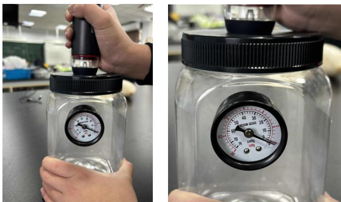
▲負壓錶上的指針不轉動，測量不出負壓值（2 張圖片由指導老師協助拍攝）
