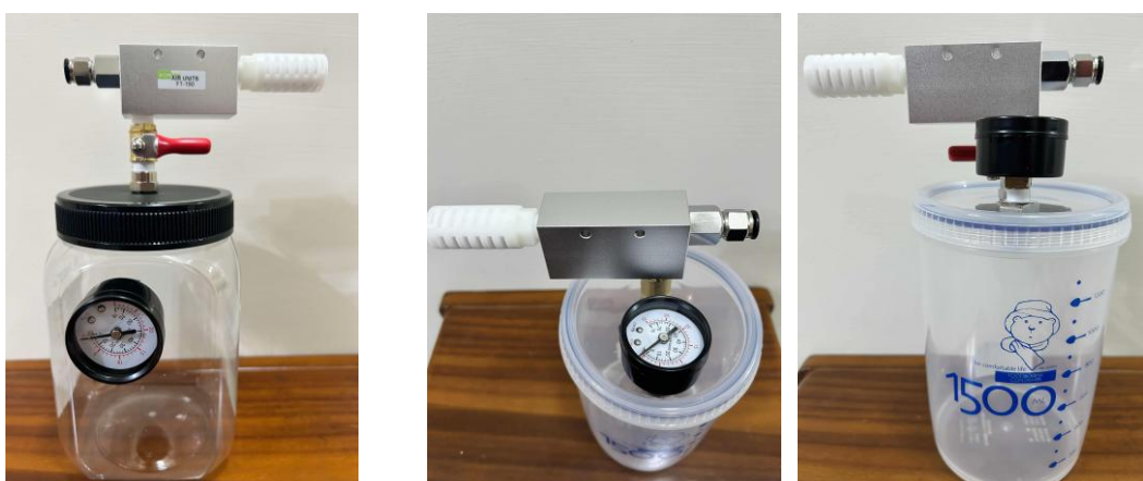
▲方形塑膠桶太薄，無法承受太大負壓，改選用較厚的圓形保鮮密封罐（3 張圖片由作者拍攝）
