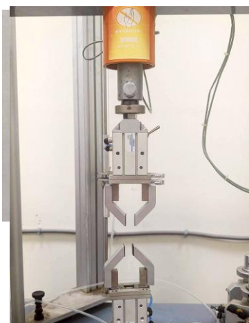
▲圖 4-2 伺服控制電腦系統拉力試驗機及夾具。 註:本圖片由聯合大學協助拍攝
