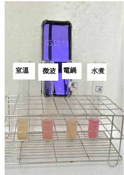
照片 10 不同回溫方式粉圓含糖檢測結果(作者拍攝)
