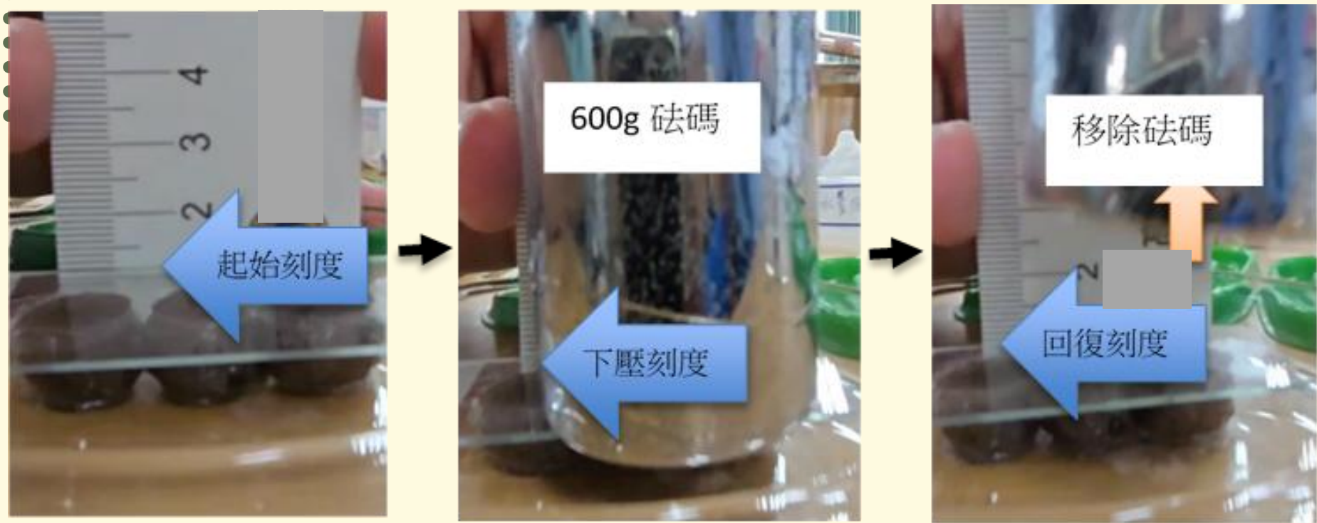
照片 11 以砝碼下壓測量不同回溫方式軟 Q 度(來源:作者拍攝)
