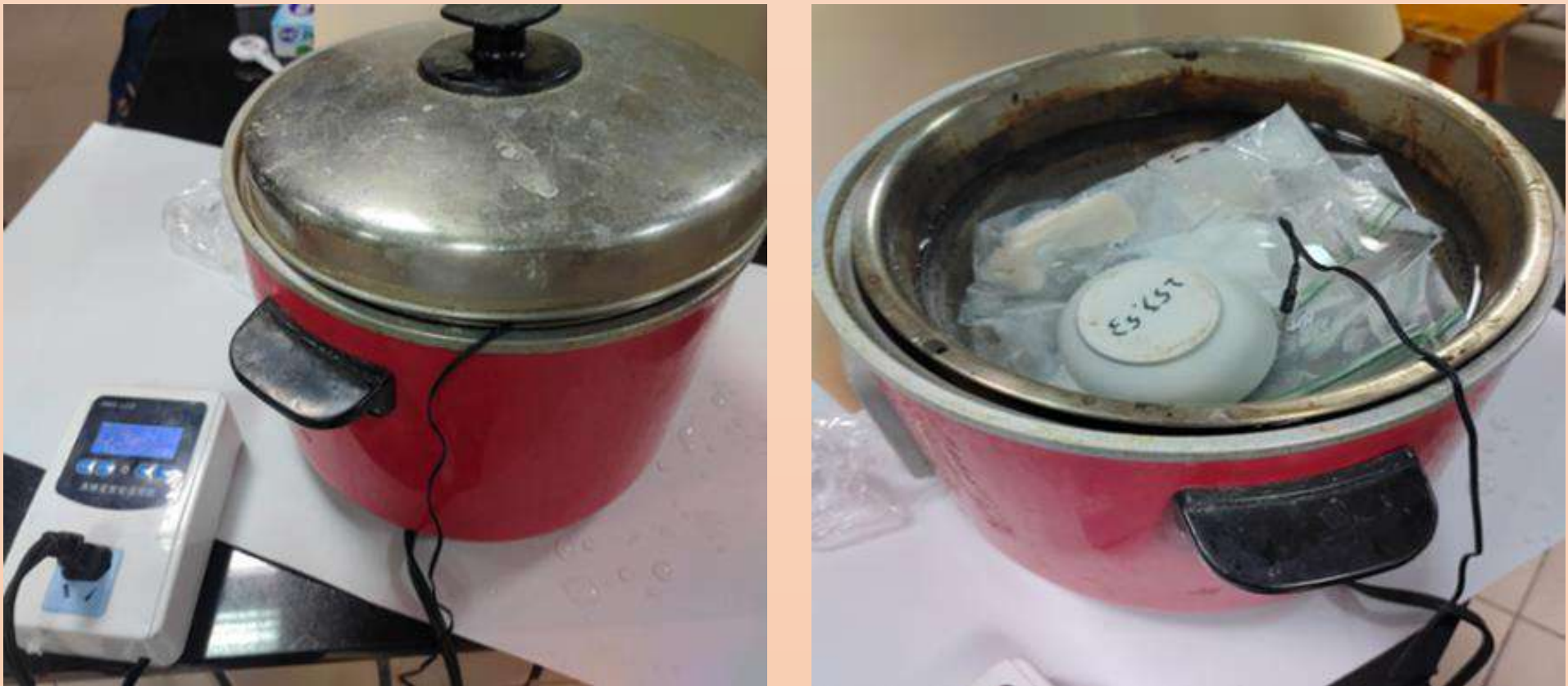
圖二 使用控溫器控制電鍋溫度並且用內鍋隔開避免雞肉直接接觸底部
