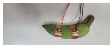
圖18. 芭蕉測試電極和測試導線照片 (作者自行拍攝)
