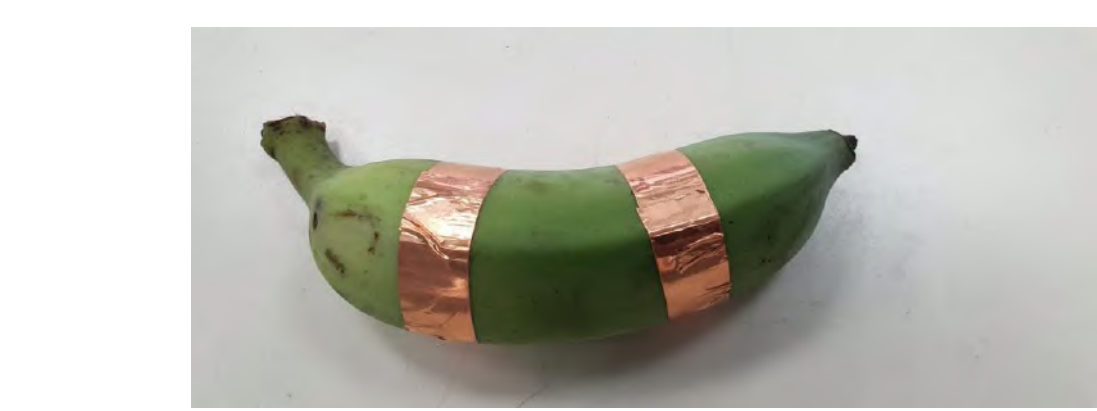
圖17.芭蕉測試電極照片
