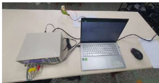
圖 29. LCR 與電腦做連線測試照片 (作者自行拍攝)
