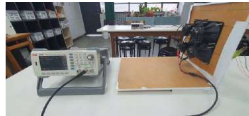
圖 24. 驅動訊號接上超音波喇叭照片 (作者自行拍攝)
