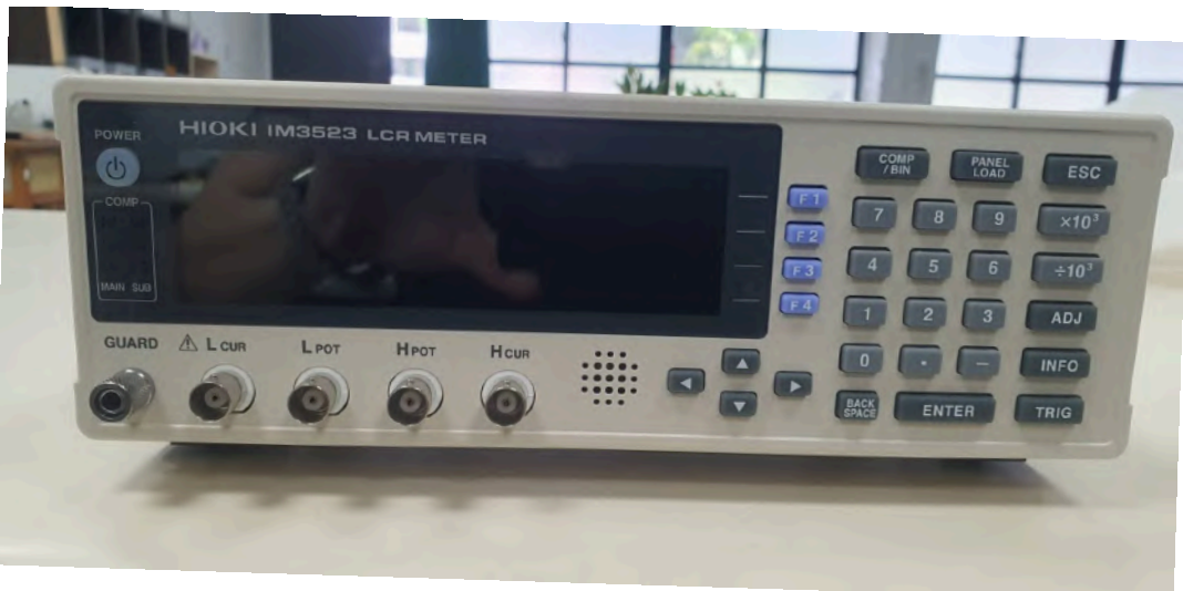
圖7.LCR (電感電容電阻)測試儀
