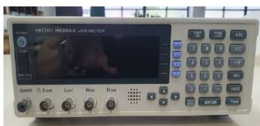
圖7.LCR (電感電容電阻)測試儀(作者自行拍攝)
