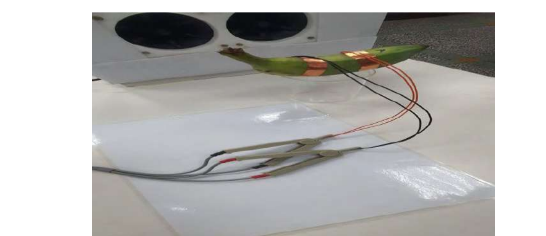
圖21.測試夾夾上AB兩電極照片
