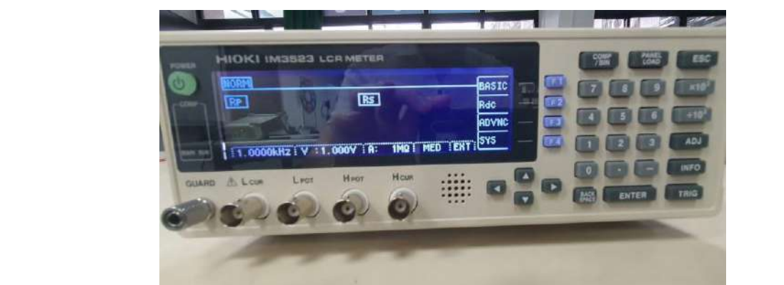
圖19.LCR設定測 R_p 及 R_s 照片
