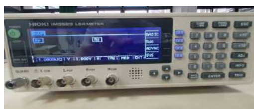
圖 19. LCR 設定測 R_P 及 R_S 照片 (作者自行拍攝)
