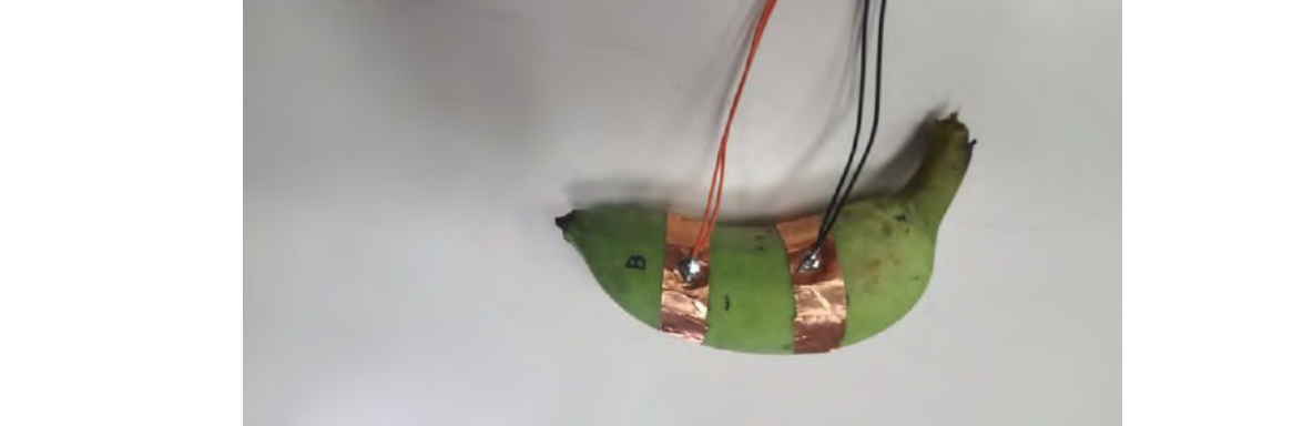
圖18.測試電極和測試導線照片
