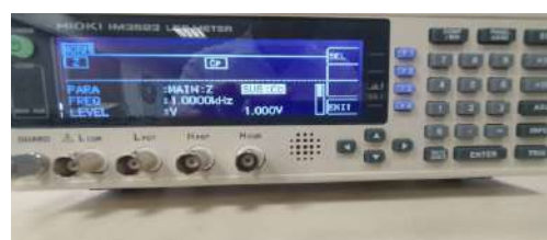
圖 20. LCR 設定測 Z 及 C_P 照片 (作者自行拍攝)
