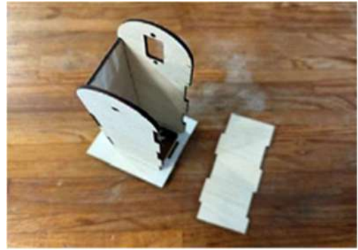
圖 3-3-6 雷射切割鋸齒狀卡榫設計
