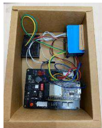
圖 18 本研究之 ESP32 設計模組 (作者 2 自行拍攝)
