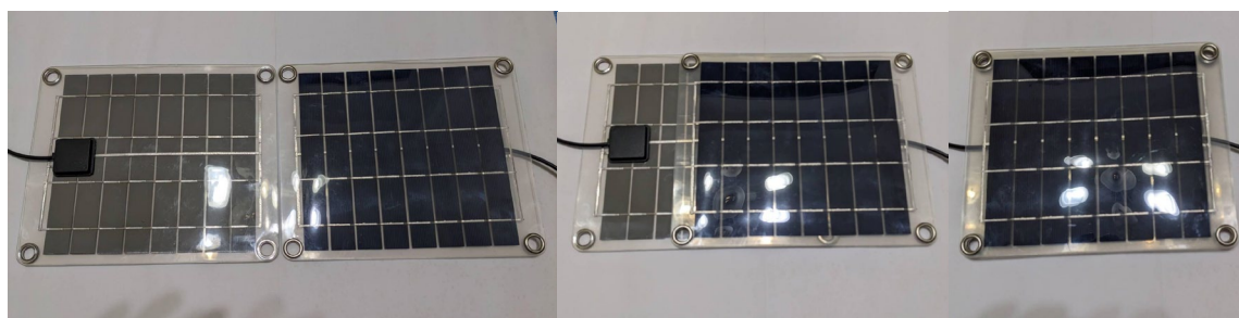
圖 2.2 (1)單面太陽板正反面; (2)將兩個單面太陽能板相疊，正面都朝外；(3)結合成為雙面太陽能板，可以獨立量測其輸出功率。(作者拍攝)
