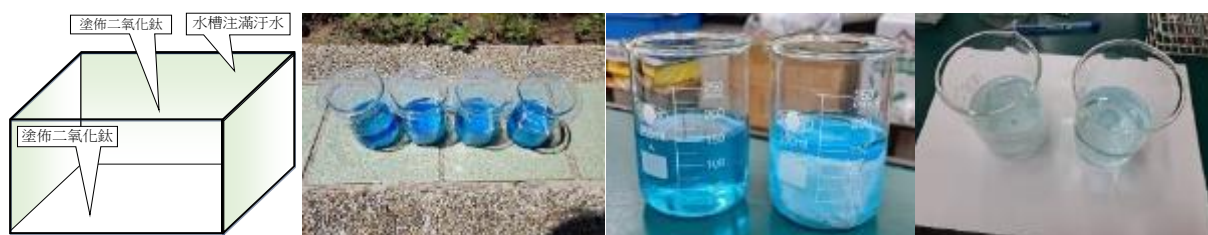
圖五-a 光觸媒單格亞甲藍液降解試驗(作者拍攝)
