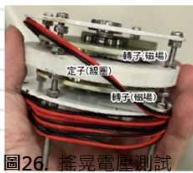
圖26. 搖晃電壓測試 (本研究成果)
