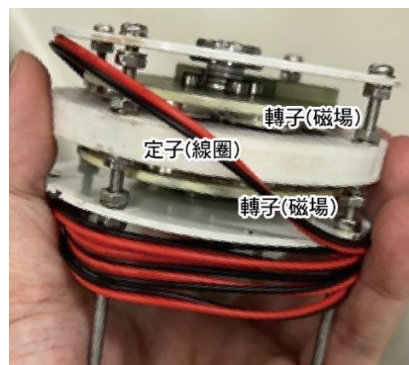
圖 26. 搖晃電壓測試。 (本研究成果)
