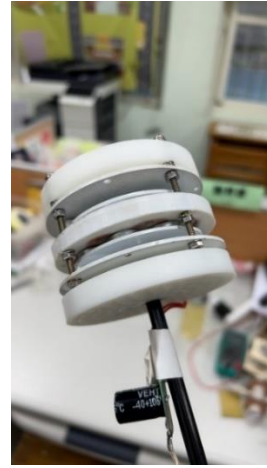
圖 32. 將發電機鎖上 3D 列印的機殼，安裝至碳纖棒上。（本研究成果）
