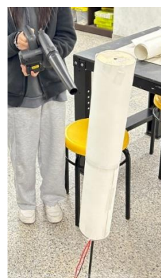
圖 36. 發電機原型柱子高度測試。（本研究成果）
