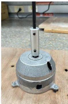
圖 33. 支柱底部連接軸承固定（本研究成果）
