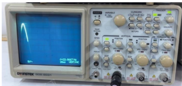
圖 37. 示波器電壓波形觀測。（本研究成果）
