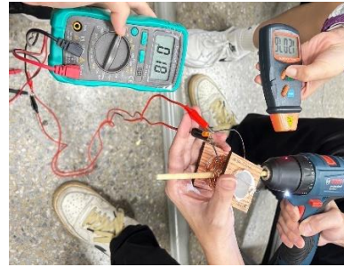
圖 13. 轉速計與三用電錶量測。 （本研究成果）。
