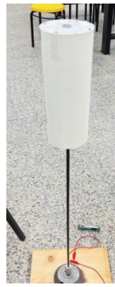
圖 35. 發電機原型柱狀高度測試。（本研究成果）
