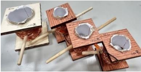
圖 12. 200/400/800/1500 圈的線圈匝數， 內置兩片強力磁鐵。（本研究成果）
