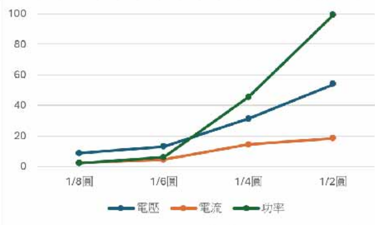
圖48. 轉子配重塊設計測試(本研究成果)
