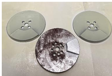
圖 23. 轉子防鏽保護製作。 (本研究成果)
