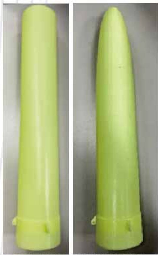
圖35/36. 圓筒/尖筒 2.5mm厚度風筒 (本研究成果)
