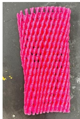
圖 39. 阻風套管（水果保護包裝套）。 （本研究成果）
