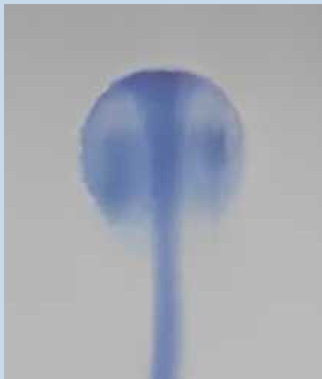
圖26 鹽度3 psu：密度差小流速慢，頭部較圓
