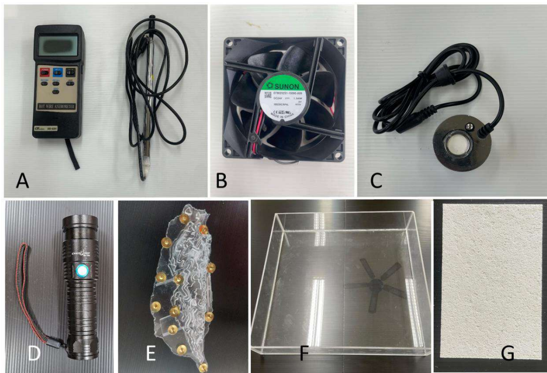
圖三、器材圖。A. 熱線式風速計 B. 24 V 風扇 C. 造霧器 D. LED 手電筒 E. 台灣模型 F. 50 cm*50 cm*8 cm 的壓克力水槽 G. 木漿棉（作者拍攝）
