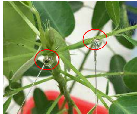
(圖3-1-10) 自製植物電壓感測器連接跳舞草 (圖3-1-11) 自製植物電壓感測器連接位置
