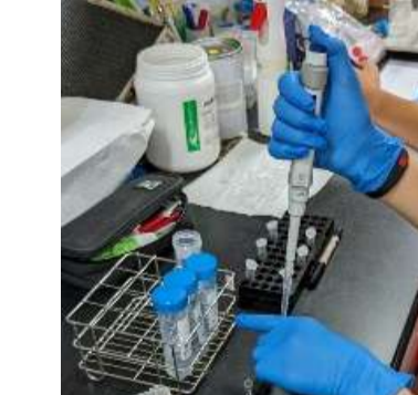
(圖 11)在樣品瓶中加入溶劑在通風櫃操作、戴口罩、護目鏡、手套、穿實驗衣
