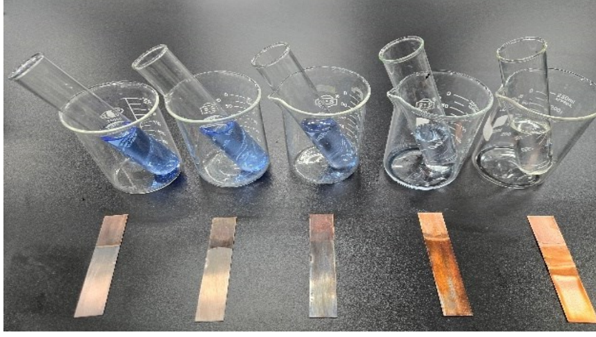
圖13：銅片放入KOH與 H 2 O 2 50min (左到右依序為 4.0、3.0、2.0、1.0 M)
